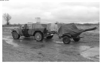
Fig. 5. TUR-2 as an artillery tractor (Source: Zakłady Mechaniczne "Tarnów" S.A.)
