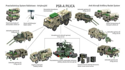
Fig. 7. PILICA configuration (Source: Zakłady Mechaniczne "Tarnów" S.A.)
